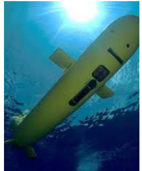
El cuerpo en forma de torpedo del AUV Eagle Ray lo hace muy hidrodinámico, lo que ayuda al vehículo a conservar energía y mapear el fondo marino durante hasta 30 horas por inmersión. Imagen por cortesía de la Universidad del Sur de Mississippi.
