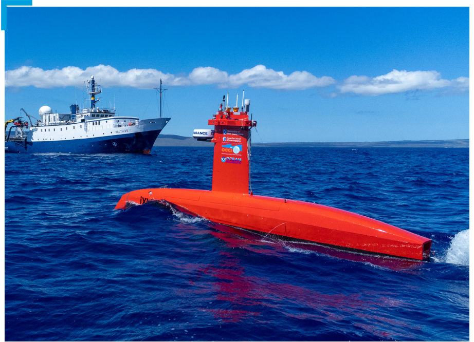
Numerosos sistemas de navegación y comunicación montados en la parte superior del USV DriX le permiten operar de forma autónoma o controlada remotamente por un piloto en tierra o en la costa. Imagen por cortesía de Ocean Exploration Trust.
