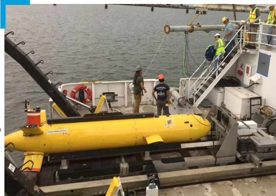
El AUV de gran tamaño Eagle Ray se encuentra sobre su Sistema de lanzamiento y recuperación (LARS), una rampa única que se utiliza para desplegarlo desde la parte trasera de un buque de investigación como el buque NOAA Okeanos Explorer. Imagen por cortesía de Leonardo Macelloni, Universidad del Sur de Mississippi.
